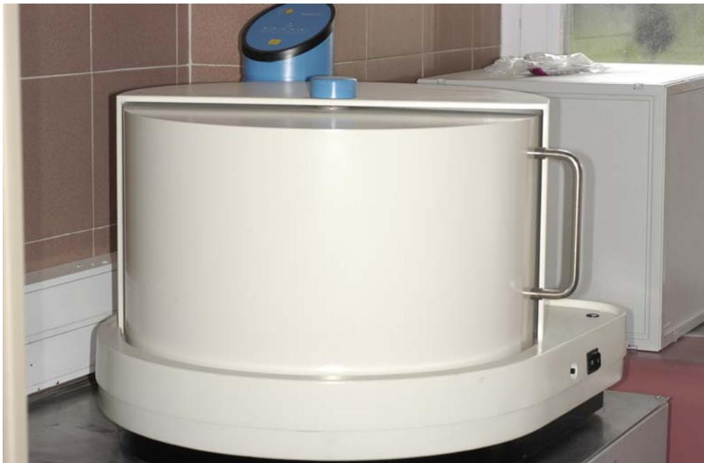
Fig. 9: Centrífuga utilizada para el colado de estructuras de cobalto-cromo y paladio-oro.
