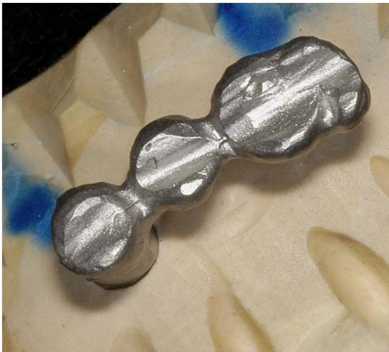
Fig. 27: Detalle oclusal de una estructura de titanio colado para puente.
