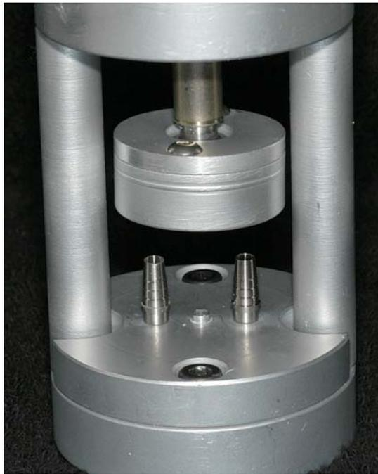
Fig. 34: Pilares colocados en la mordaza para el cementado de una estructura de puente.
