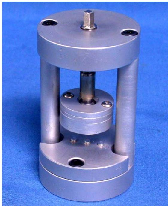
Fig. 33: Mordaza diseñada para el cementado de las estructuras.
