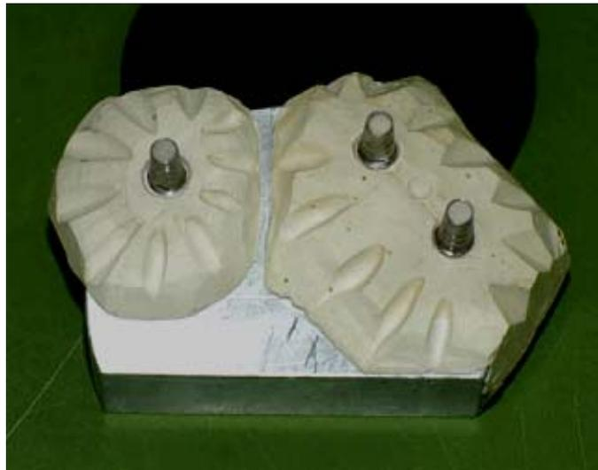
Fig. 3: Soporte con escayola para reforzar las uniones análogo-pilar.
