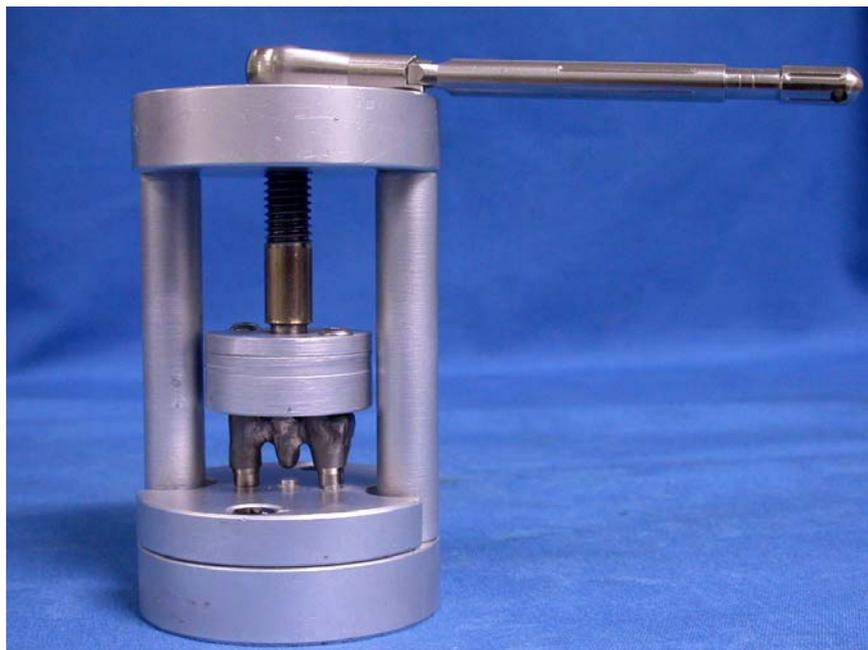
Fig. 38: Colocación de la llave dinamométrica para el mantenimiento de la fuerza constante durante el cementado de una estructura colada para puente.
