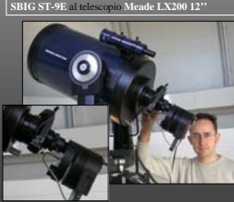
El Prof. David Montes ajustando la cámara CCD SBIG ST-9E al telescopio Meade LX200 12"
