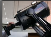
Fotómetro fotoeléctrico OPTEC SSP-3 acoplado al telescopio Celestron 11"
