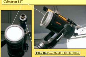
Filtros H \alpha (SolarMax40 + BF10) < 0.8 Å
