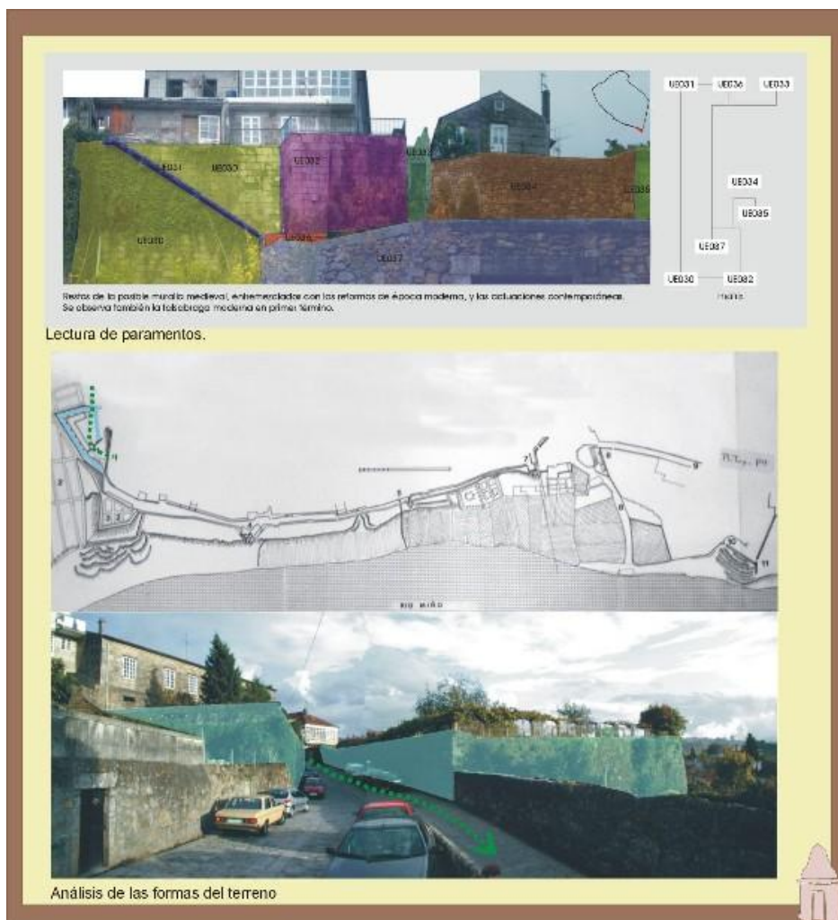
FIG 19. Distintos procesos del análisis de la fortificación de Tui: lectura de paramentos y análisis de las formas del terreno.
